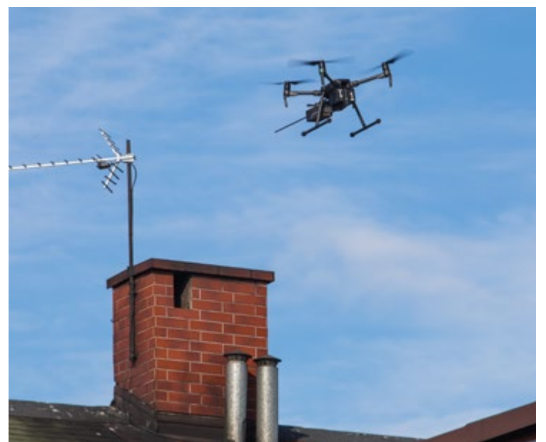
Dron wyposażony jest w głowicę badającą zawartość dymu
